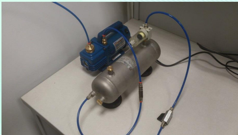
A vákuum szivattyú és a puffer tartály képe, a részecske szűrővel és a visszacsapó szeleppel
